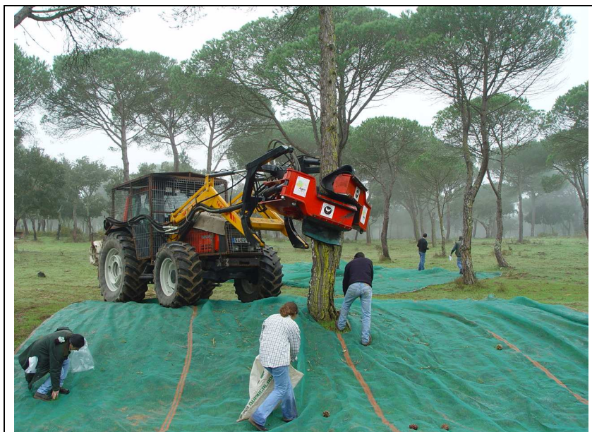
Fig. 3 – Vibrador mecânico para colheita de pinha montado no carregador frontal de um tractor agrícola
